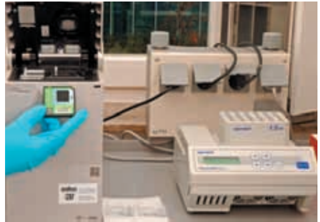
RNA / DNA Qualitätskontrollen werden mittels des Agilent Bioanalyzers durchgeführt
