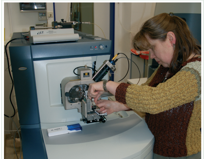
Die Proteomik hat ein neues High-end-Massenspektrometer erhalten. Das Q-TOF-Premier wird für die Proteinidentifizierung und die labelfreie Proteomexpressionsanalyse eingesetzt. (s. Pulsschlag Juni 2008, S. 19)
