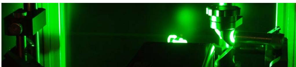
*Im Rahmen der Abschlussarbeit soll die Wellenlängenabhängigkeit der MALDI-Performance neuartiger und etablierter Matrices mithilfe eines UV-OPO-Lasersystems untersucht werden. Der Hauptaspekt der Arbeit beinhaltet instrumentelle Arbeiten zur Einkopplung des Laserstrahls und die Vermessung der MALDI-Performance von Matrices mithilfe eines orthogonal-extrahierenden Flugzeitmassenspektrometers.*
